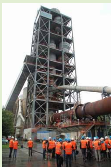
Slika 1. Rotacijska peč za proizvodnjo cementnega klinkerja.
