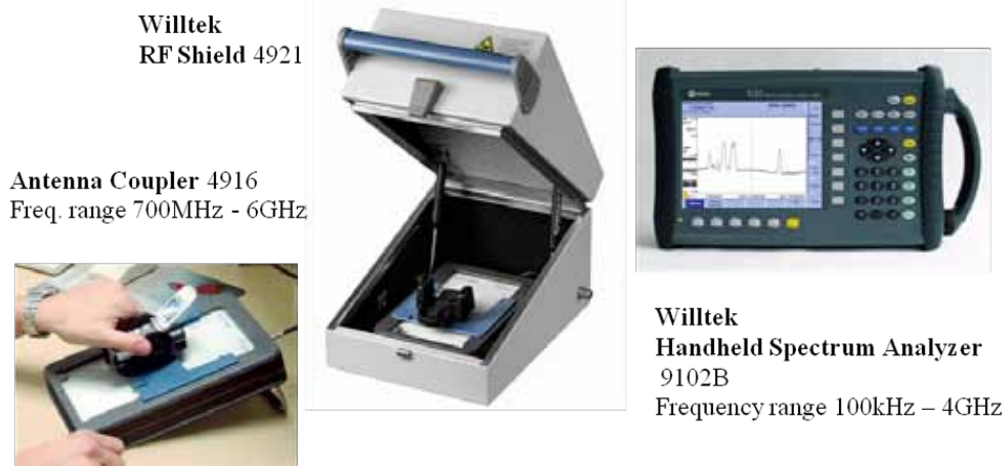
Slika 1: Specijalizirane i etalonirane opreme za merenje zračenja mobilnih telefona
