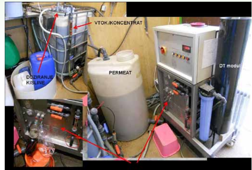
Slika 1.: Postavitev pol-industrijske filtracijske naprave RO 200 DT, ROCHEM, Nemčija/Crystal Clear, Avstrija, v obratovanju na odlagališču. 5)
