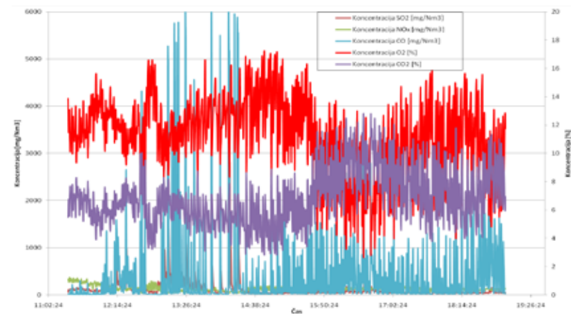
Slika 6: Koncentracija posameznih plinov v dimnih plinih v času zgorevanja vzorca RV 02
