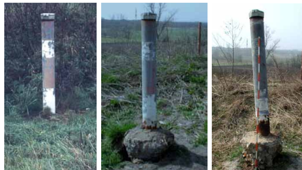
Slika 3: Prikaz pospešenega posedanja odlagališča z izvajanjem in-situ stabilizacije na način prisilnega prezračevanja (časovno zaporedje slik: začetek september 1999, april 2002, marec 2003), vir: Hamburg University of Technology, Institute of Environmental Technology & Energy Economics
