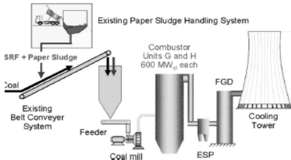
Slika 2 prikazuje sistem doziranja SRF in papirnega mulja v tej elektrarni.
