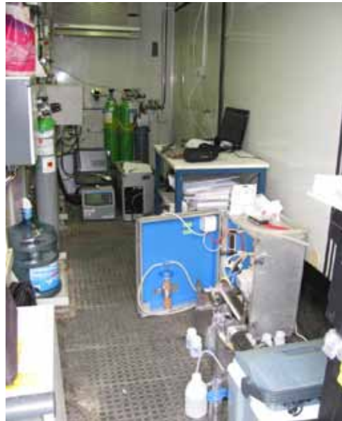
b) Merilni sistem za občasne meritve emisij snovi v zrak
