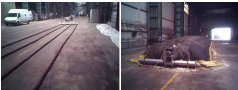
Slika 7: Prezračevalne cevi in prekrivna membrana Gore®Cover
