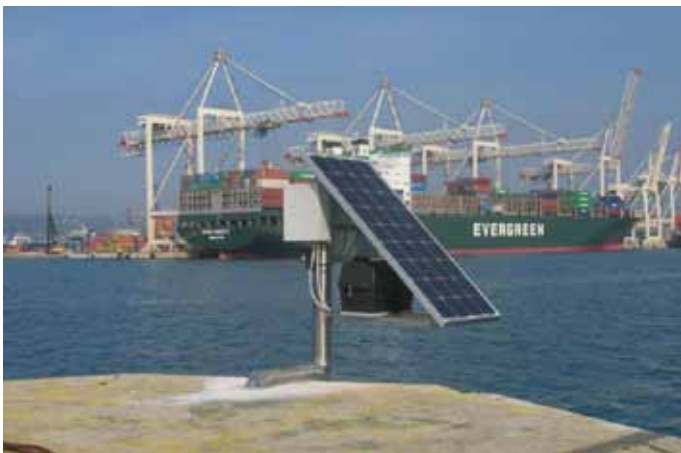
Slika 8: Naprava za spremljanje kvalitete morja, vir [5]
