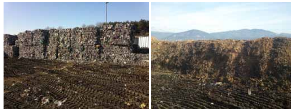
Slika 8: Produkti mehansko-biološke obdelave (lahka gorljiva frakcija-slika levo in biološko stabilizirana težka frakcija-slika desno)
