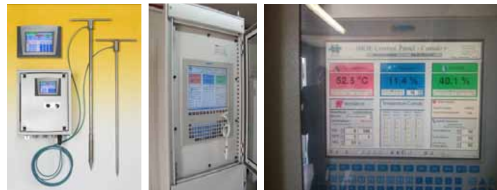
Slika 2: Krmilna tehnika in merilne sonde Bioe®Control Gore®Cover
