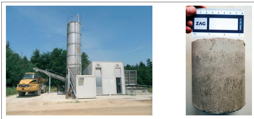
Slika 1: Naprava za predelavo komunalnega blata v geotehnični kompozit (levo), vzorec kompozita iz predelanega blata, z dodatkom kalcijskega pepela (desno).
