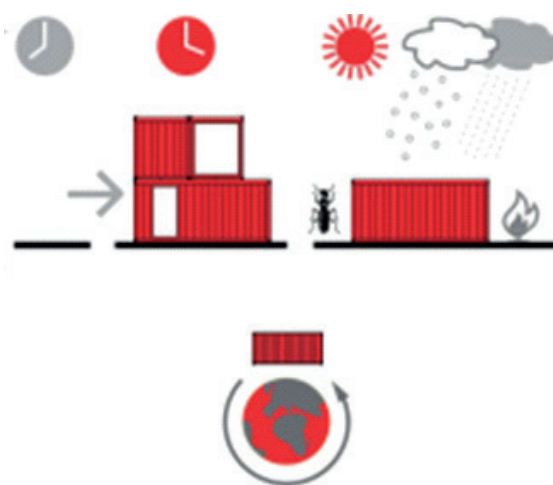
Slika 1, 2: Lastnosti kontejnerske gradnje
