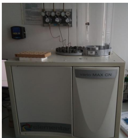
Slika 2: Aparatura za merjenje ogljik/dušik (C/N) razmerja Elementar VarioMAX CN, (foto: Žitko V.).
