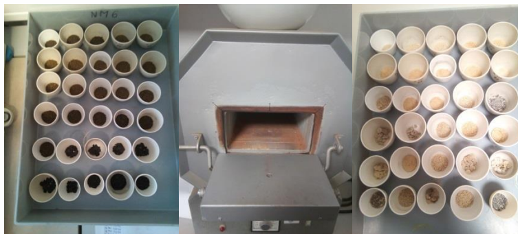
Slika 1: Prikaz postopka za merjenje hlapnih trdnih snovi v vzorcih, foto: (Žitko V.).
