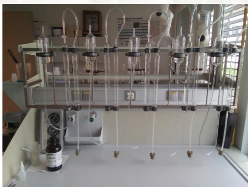
Slika 4: Sistem za merjenje vsebnosti karbonatov, (foto: Žitko V.).
