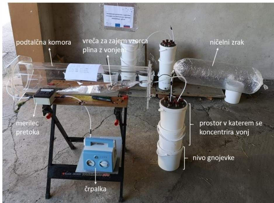
Slika 17: Sistem zajemanja plina z vonjem na pilotnem poskusu na kmetiji.
