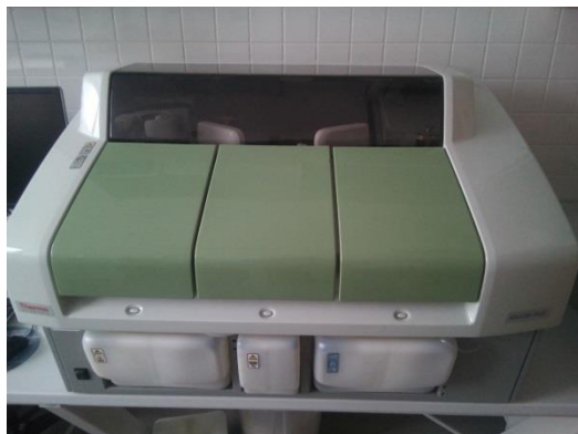
Slika 3: Aparatura Thermo Scientific Gallery za merjenje nitratnega (NO 3 -N) in amonijskega (NH 4 -N) dušika (foto: Žitko V.).
