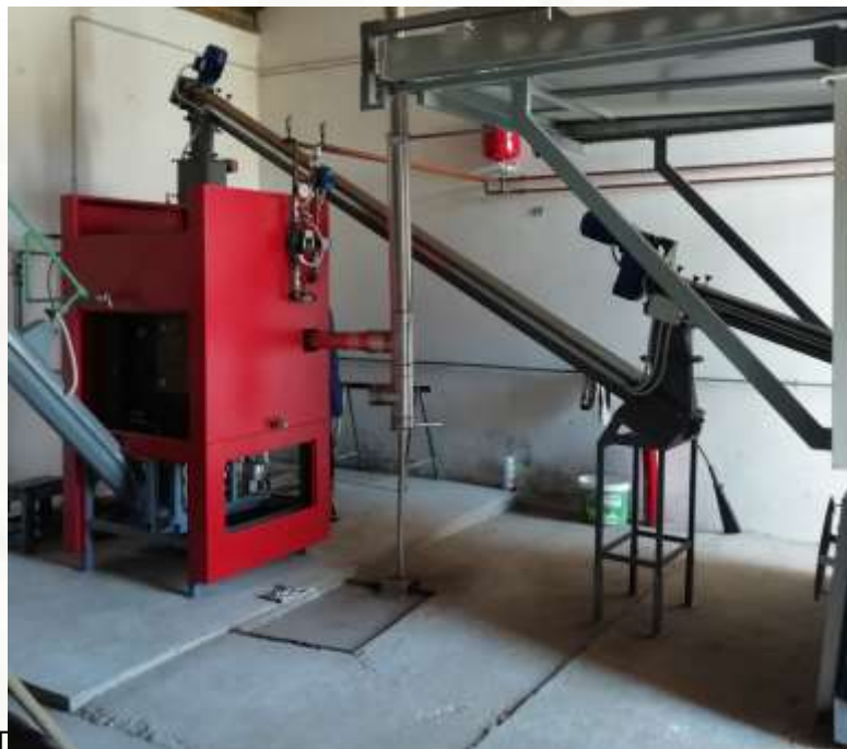
Slika 3: Transportni sistem iz zalogovnika do pirolizne peči in pirolizna peč
