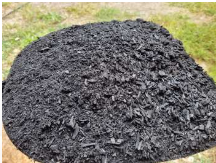
Slika 7: Proizvedeno biooglje iz pirolizne peči KOPI.
